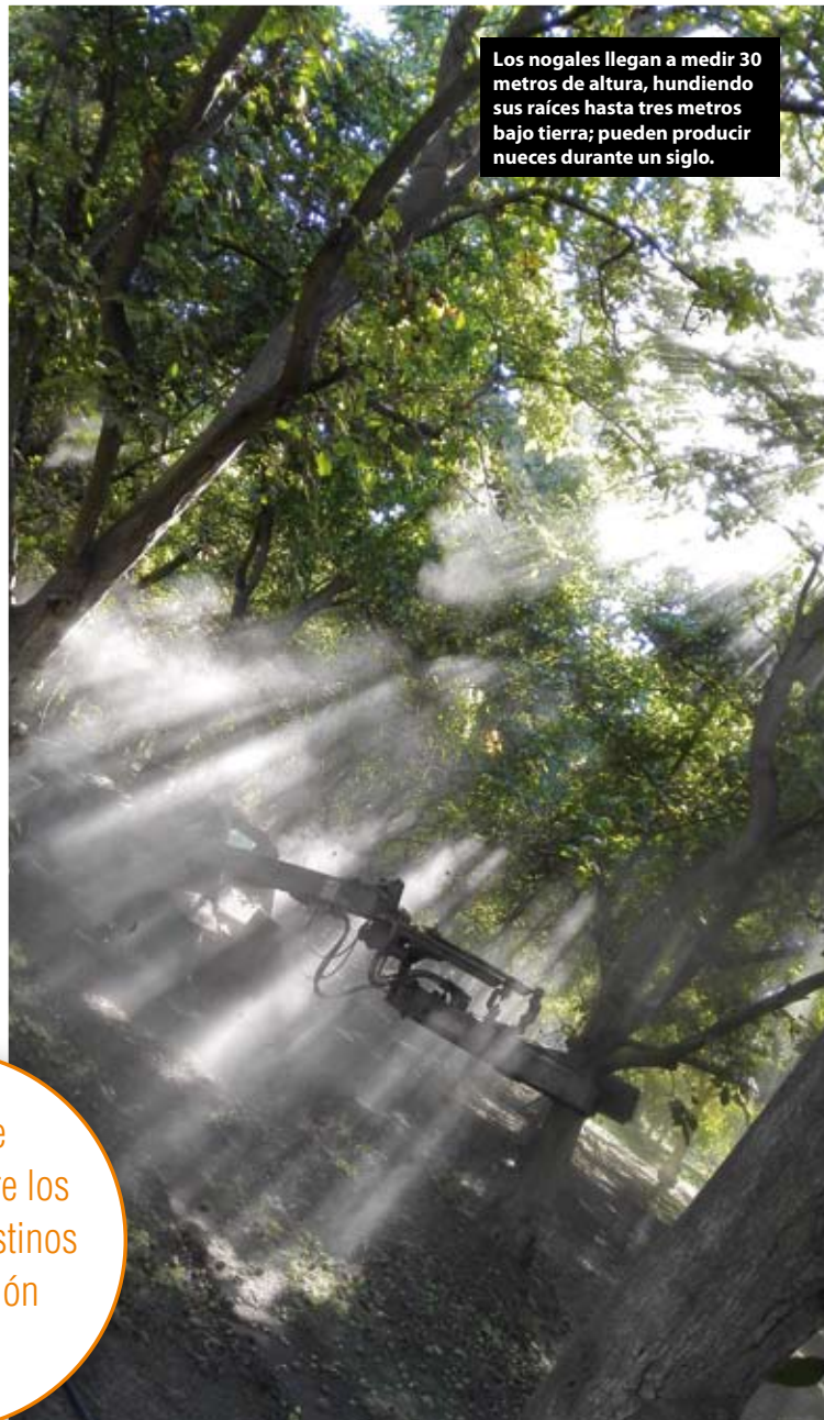
Los agitadores provocan que las nueces caigan de los nogales, siendo recogidas posteriormente del suelo por cosechadoras mecánicas.
